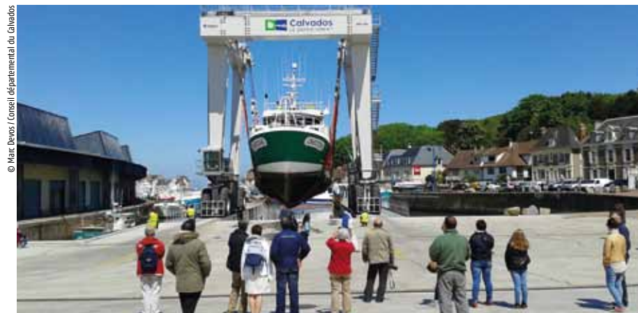
Le « roulève » de Port-en-Bessin-Huppain peut soulever du lourd : ici le Vauban, 300 tonnes, 20 m de long.
